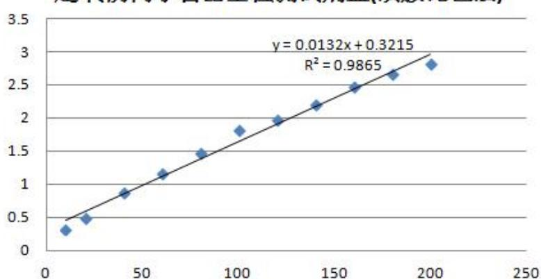
根据结果可以看出  $\text{NO}_2^-$  标准在 160 $\mu\text{M}$  以上时，OD 值会有偏差，因此样品的  $\text{O}_2^-$  应小于 320 $\mu\text{M}$ 。
